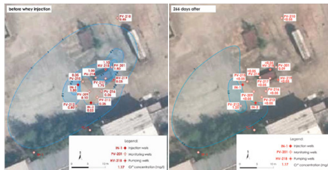
Lokalita Kortan - Koncentrace Cr(VI) v podzemní vodě před a po aplikaci substrátu
