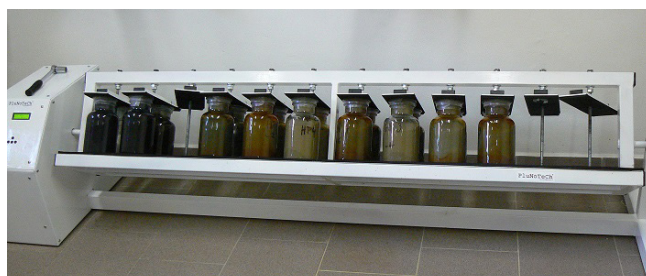
Vsádkové laboratorní testy bio-redukčního potenciálu
