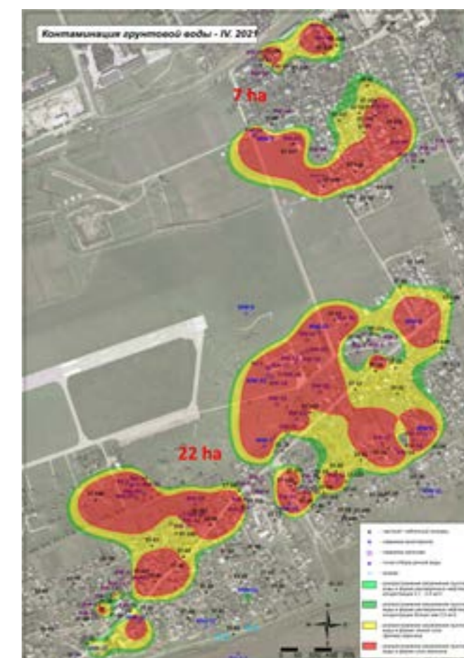
Rozsah kontaminace ve formě volné fáze ropného produktu na hladině podzemní vody (červené plochy).
